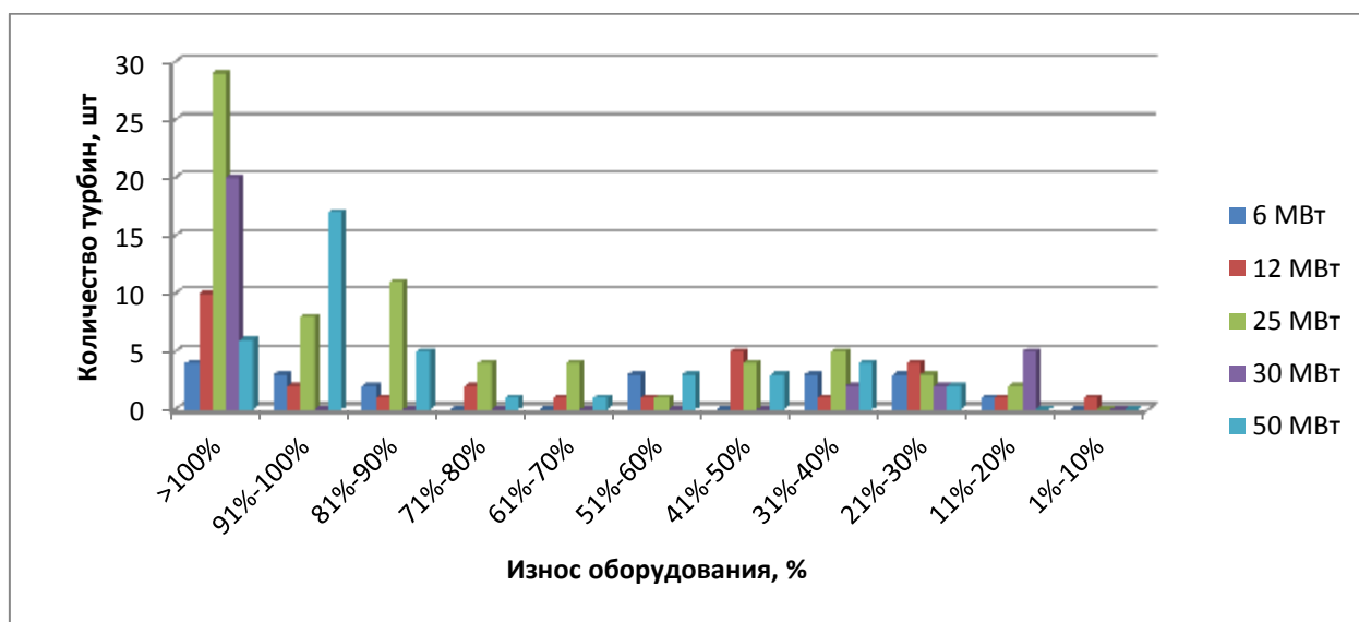
Рисунок 6 - Распределение наиболее распространенных турбин типов П, Т, ПТ и ПР по износу оборудования (шт.; %).
